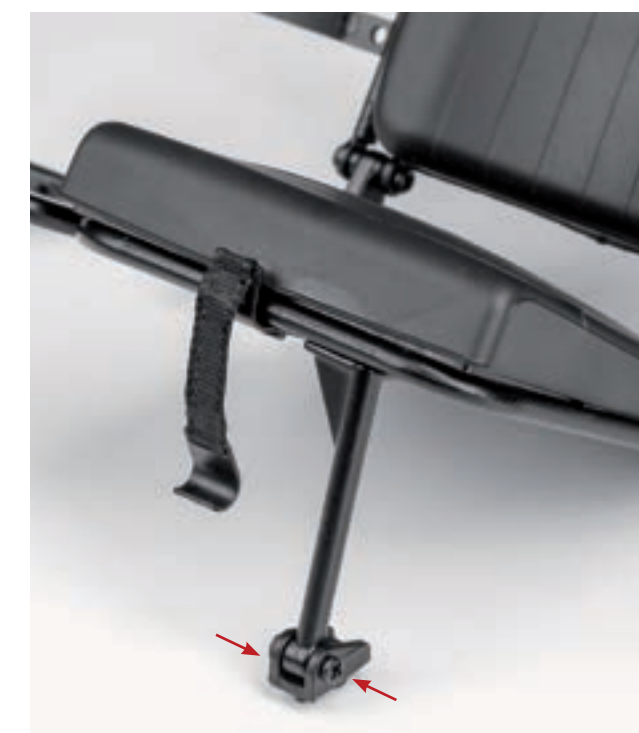
Шаг 7. Аналогичным образом установите и закрепите оставшуюся петлю на левой стойке каркаса основания заднего сиденья. Для фиксации используйте два винта 1,7×3 (LM). По окончании монтажа проверьте подвижность петель относительно каркаса заднего сиденья.
